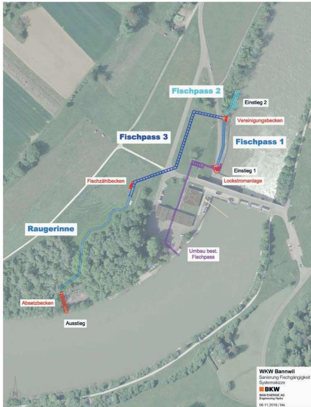
Abb. 1: Situation der neuen Fischaufstiegshilfe am Kraftwerk Bannwil
