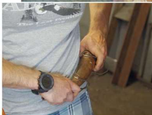
Bild links: Durch die von Hand aus Messingblech geschmiedete Form erhält das Horn eine gute Passform, um nahe am Körper getragen zu werden.
