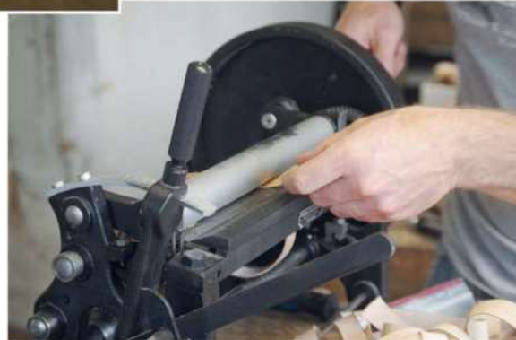
Bild unten: Da das verwendete Wildleder meist zu dick ist zum umwickeln, wird es mit einer speziellen Lederspaltmaschine "gespaltet".
