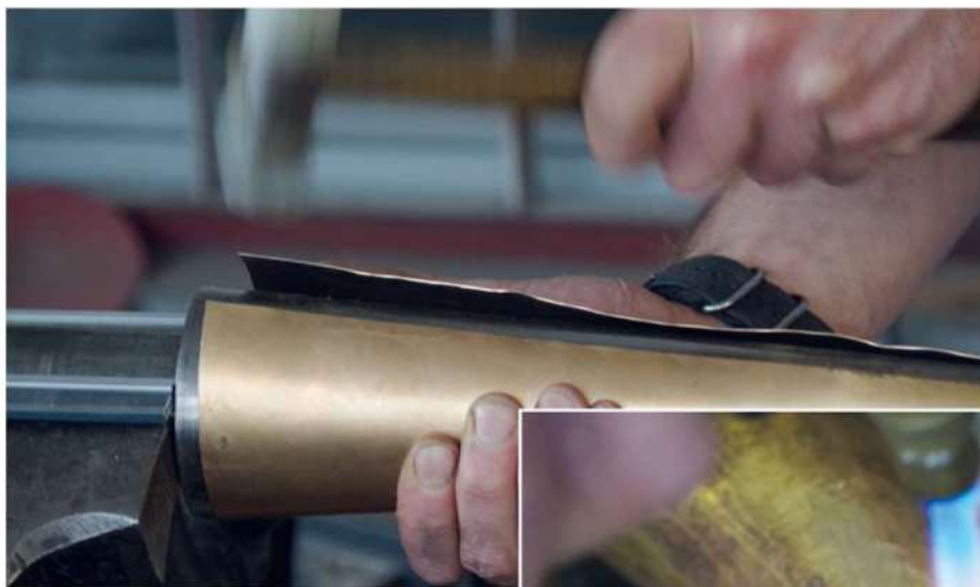
Bild links: Von Hand, mit Hammer, wird der Rohling in Trichterform gebracht.
